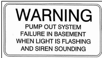
**BASEMENT PUMP OUT FAILURE WARNING SIGN**
